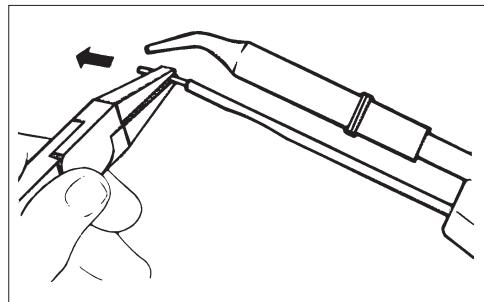
Il fondente dello stagno può provocare l'ostruzione dell'estremità del tubo guida. Se necessario, pulirlo.
