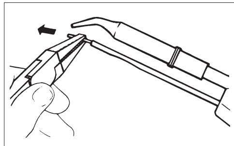
Le flux d'étain peut parfois obstruer l'extrémité du tube guide. La nettoyer si nécessaire.
