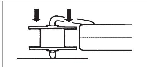
Retirer les résidus d'étain demeurant à l'intérieur du tube guide avant d'introduire la nouvelle bobine.
