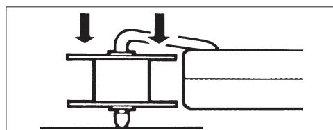
Zur Entnahme der Spule das Ende der Achse auf eine feste Oberfläche auflegen und anschließend gegen die Spule drücken, bis diese nachgibt.
